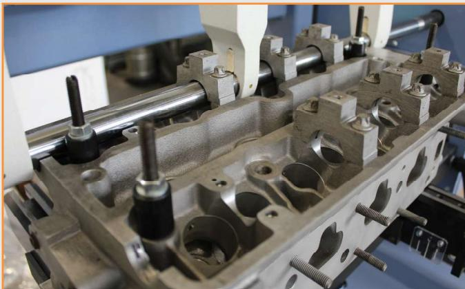
La barenatrice orizzontale LBM950 consente il ricondizionamento delle sedi di alloggiamento degli alberi a camme delle testate e degli alberi a gomito dei monoblocchi di vetture e veicoli commerciali.
